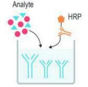
1. 对应板孔中加入50µL标准品工作液或 样本后,立即每孔加入100ulHRP酶标 抗体工作液,37℃解育60分钟
