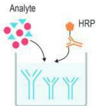
1. 对应板孔中加入50 $\mu$ L标准品工作液或样本后，立即每孔加入100 $\mu$ l HRP酶标抗体工作液，37°C孵育60分钟
